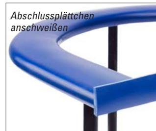
Bei **unifarbenen Profilen** können die Stirnseiten mit einem Abschlussplättchen, das aus einem Profilrest zurecht geschnitten wird, verschweißt oder verklebt und sauber verputzt werden. Die Verschweißung von Abschlussplättchen und Haltestegen wird mit einem Schweißkolben vorgenommen. Bei den **Metallic-Farben** zeigt sich die Schweißstelle als dunkler Strich. Die Stirnseiten können alternativ mit einem Formteil versehen werden.
