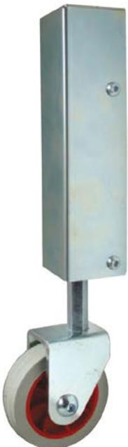
■ Torrolle als Unterstützung bei schweren Toren. Gleicht Unebenheiten im Boden aus. Zum Anschrauben, verzinkt. Verstellbar um ca. 30mm. Maximales Torgewicht ca. 200 kg.
